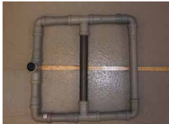
Figur 42: forsøgsopstilling 4 med perforeret gummistrømpe
