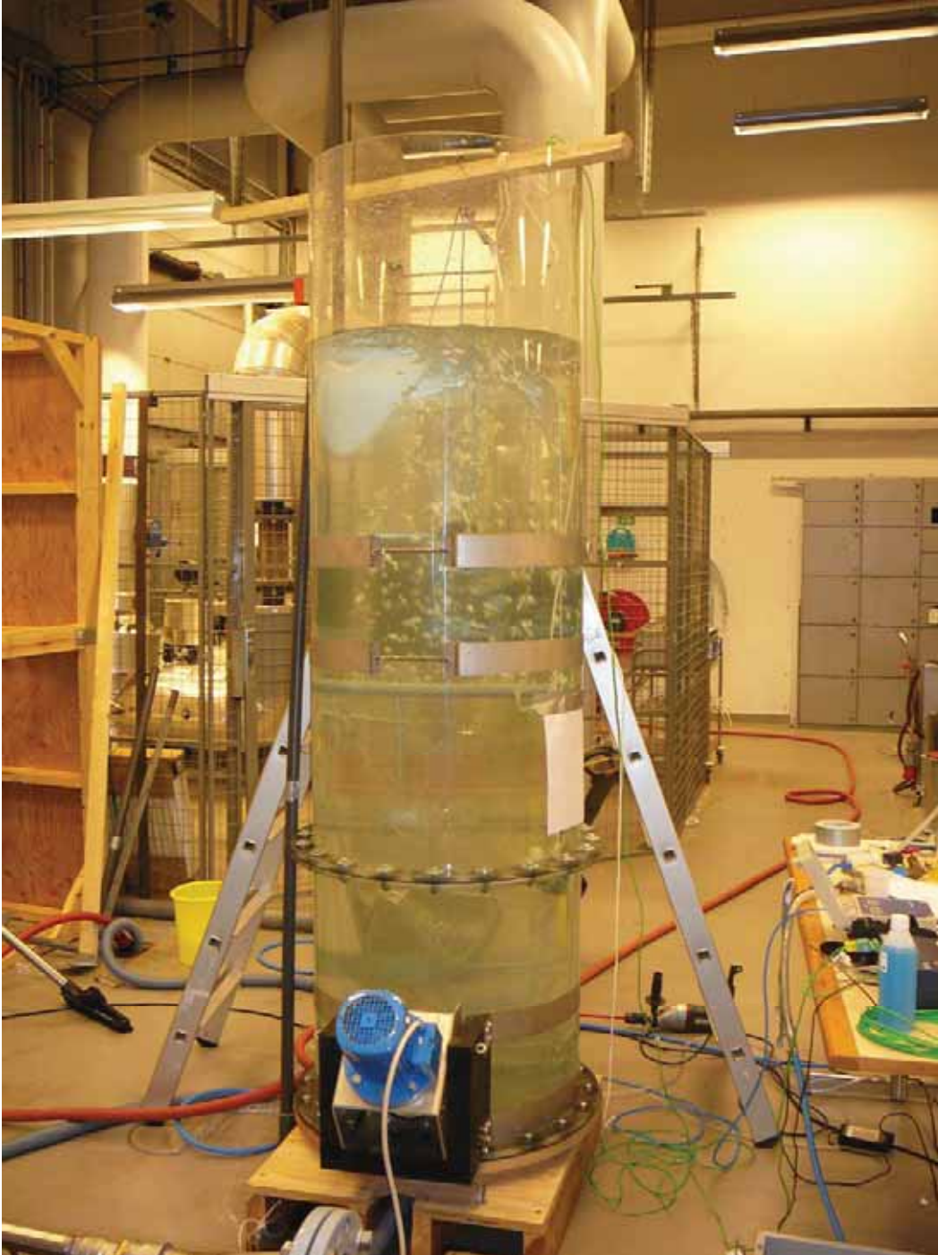
Figur 39 forsøgstank med diffusor, 0,81 m under vandspejl
