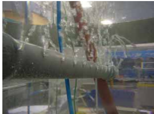
Figur 41: forsøgsopstilling 2 med 0,5 mm. huller
