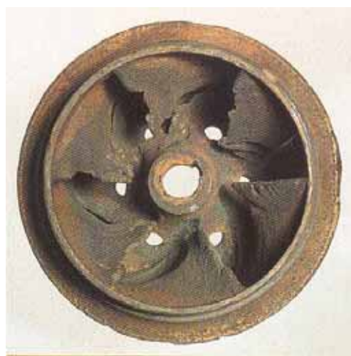
Figur 26: Eksempel på erosions korrosion i et løbehjul af støbejern. Kilde: Korrosion Atlas, steel metals
