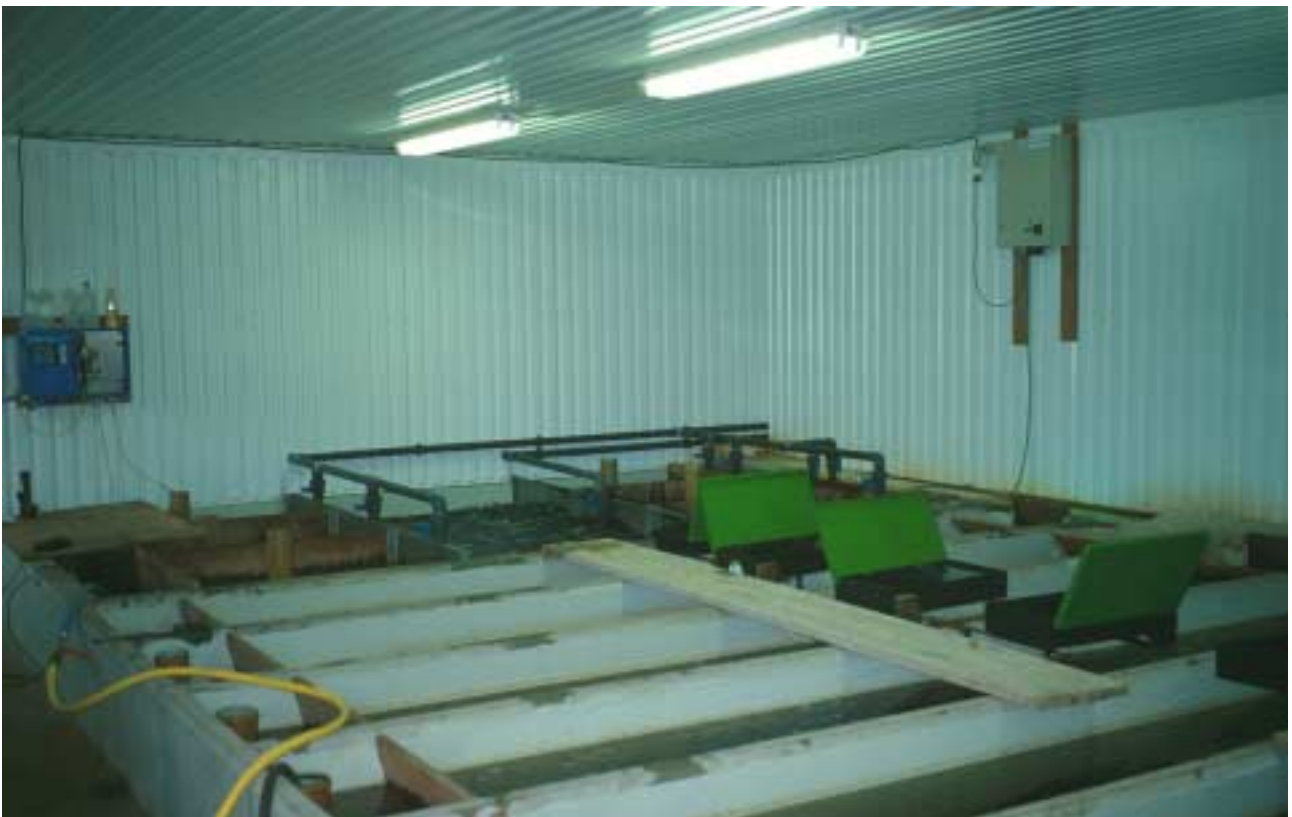
Figur 3 : Forsøgsanlæggets afdeling med yngelkummer. Bagest ses det 3-delte biofilter.
