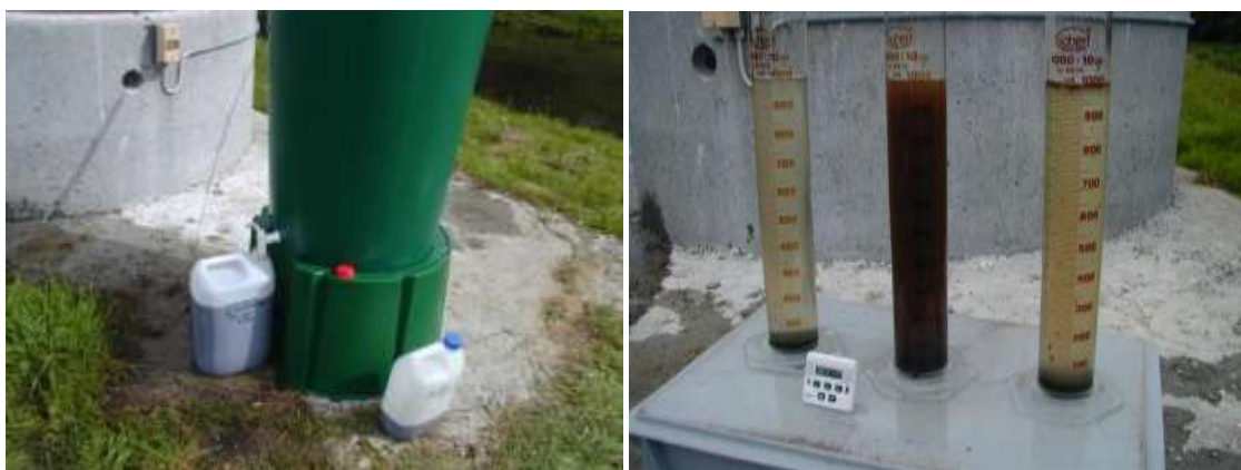
Figur 5-3 Opsamling af koncentreret slam (tv) og eksempel på opkoncentrering i plexiglasrør (th).
