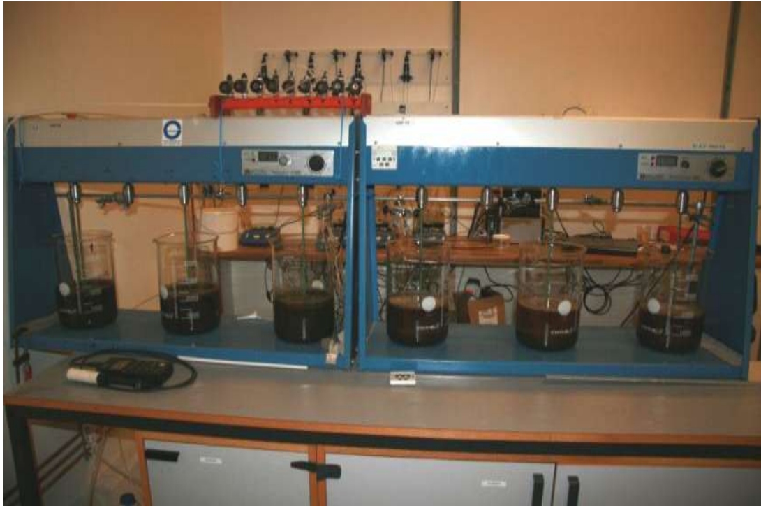
Figur 6-1 Forsøgsopstilling i DHI's spildevandslaboratorium til belysning af slamhydrolyse.
