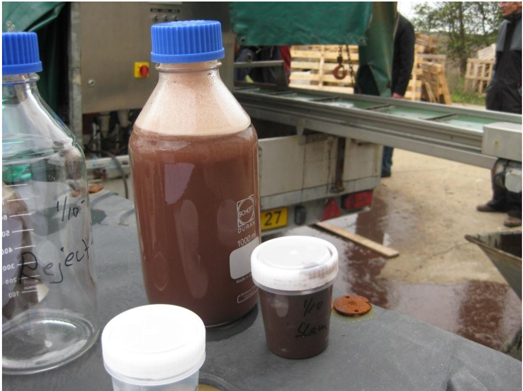
Figur 3. Rejektvand og koncentreret slam
