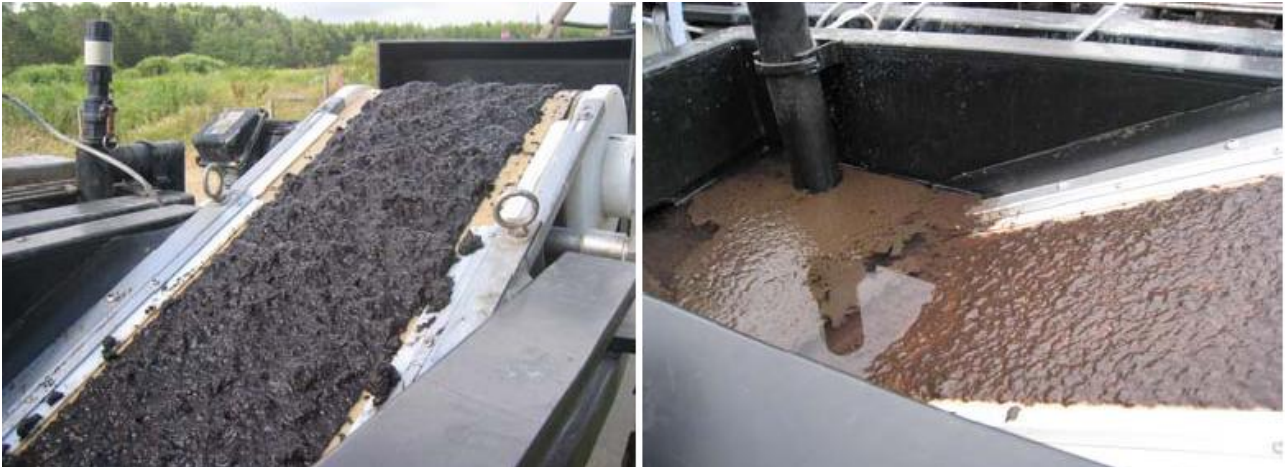
Fig. 6: Til venstre ses slamdelen ved korrekt dosering af fældningsmiddel ( AlCl_3 ) og polymer. Til højre ses tyndt slam som følge af ufuldstændig flokkulering.
