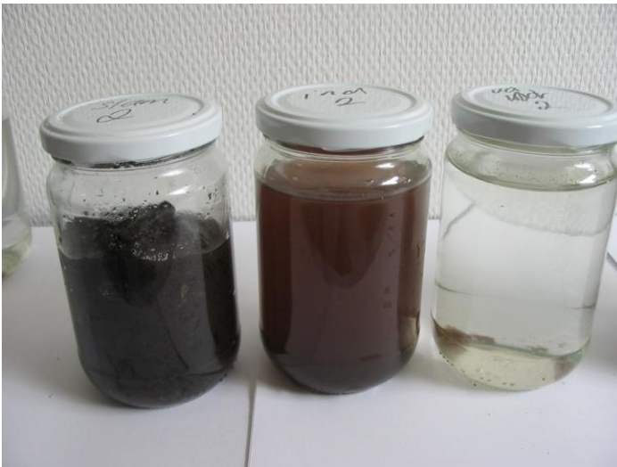
Fig. 7: I midten slamvand før fældning. Til venstre slam og til højre rejktvand.
