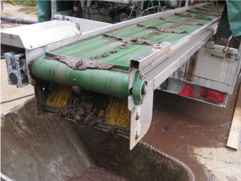
Figur 4. Opkoncentreret slam på transportbånd.
