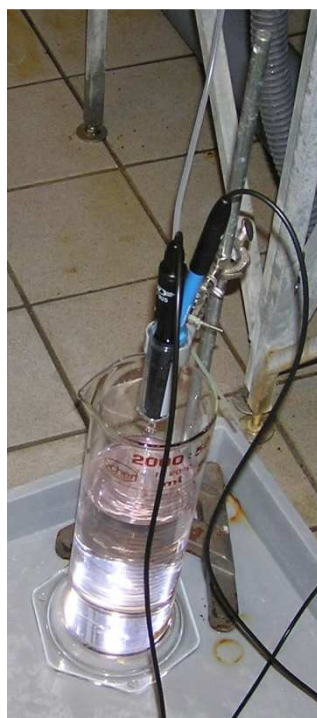
Figur 2 Prober til måling af temperatur, pH og ledningsevne. Udløbsvandet fra søjlen pumpes over i 50 ml røret med proberne via en slange i bunden af røret. Overløbsvandet fra rørene samles derefter i et opsamlingskar.
